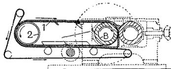
unterhalb der Walzen angeordneten Förderband, dad. gek., daß ein zweites endloses Band (1) vorgesehen ist, das über die eine Mahlwalze (B) und eine verschiebbare Spannwalze (2)
